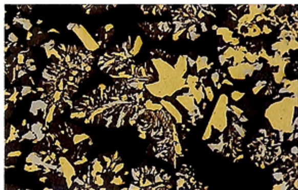
写真12 小規模チムニー (412-3) の壁面を構成する硫化物の反射顕微鏡像 写真の横幅が0.5mm。黄色が黄銅鉱、灰色が閃亜鉛鉱、白色が方鉛鉱である。樹枝状組織は急速成長を物語る。
