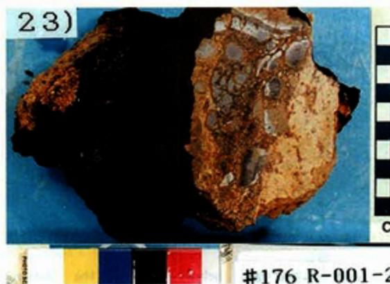
写真 23 舗装タイプマンガン断面。内部に玄武岩の破片を持つ。
