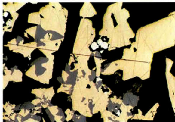
写真 7 熱水の通路と思われる空隙に接した部分の閃亜鉛鉱を交代したと考えられる黄銅鉱。チムニーの崩壊物と思われる鉱石塊 (No. 152-3a)
