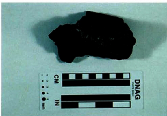
写真 2 熱水の通路と考えられる連続した空隙に平行に硫化鉱物の濃集した縞状構造を持つ鉱石礫 (No. 152-1a)
