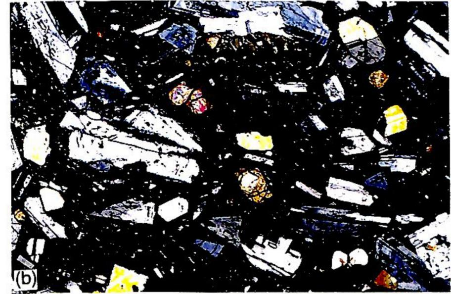
写真 5 火山岩 (Dive 875-R1) の薄片顕微鏡写真。(a) はオープンニコル (b) はクロスニコル, Pl は斜長石, Ol はかんらん石, Cpx は単斜輝石を示す
