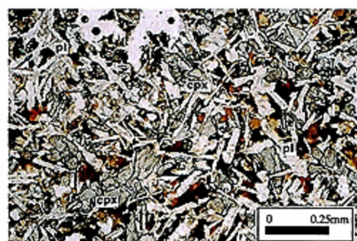
写真21 S-3海山基底部から採取されたドレイトの薄片写真 pl=斜長石 cpx=単斜輝石
