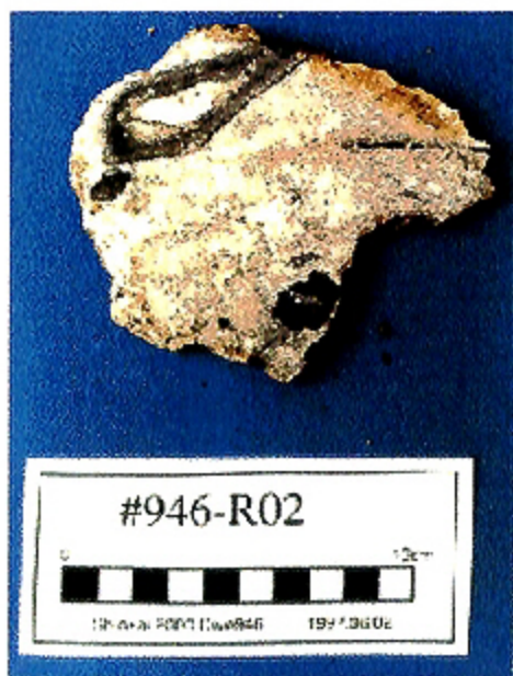
写真3 矽化変質を受けた火山砕屑岩 ((2K-#946R2) Photo.3 Altered pyroclastic rock (2K-#946R2).
