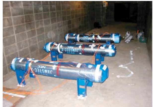
写真2 比較観測のために気象庁精密地震観測室に設置された3台の釧路システム海底地震計。観測終了後の1999年7月、実際に3台とも釧路沖海底に設置された。
