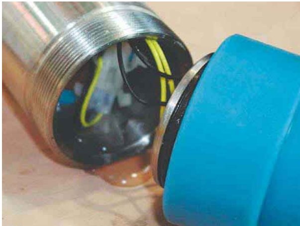
写真8 浸水したトランスポンダ。 Photo 8 Flooded transponder.
