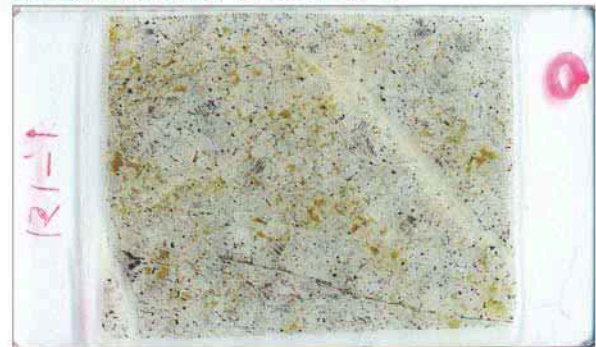
写真4 大町海山蛇紋岩(原岩タイプ:かんらん石・単斜輝石キュムレイト) 蛇紋石化したかんらん石単斜輝岩の研磨断面(上)とその薄片写真(下)。試料番号: 6K#571_R1-1。薄片写真の透明部分はキュムラス単斜輝石。その粒間を変質したかんらん石(褐色部分)が埋める。ヘテラドキュムレイト組織を示す。
