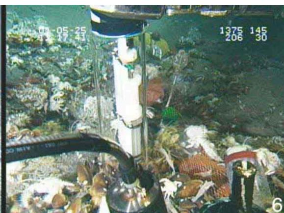
写真6 微量採水器による採水。第四与那国海丘Site 10Y。
