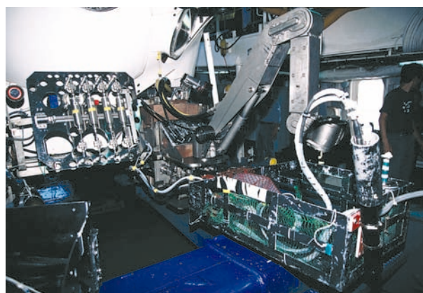
写真3 WHATSを「しんかい6500」のペイロードに装備したところ。写真右端のサンプルバスケット前部に収納されているのが温度計付きの採水器吸入口。
