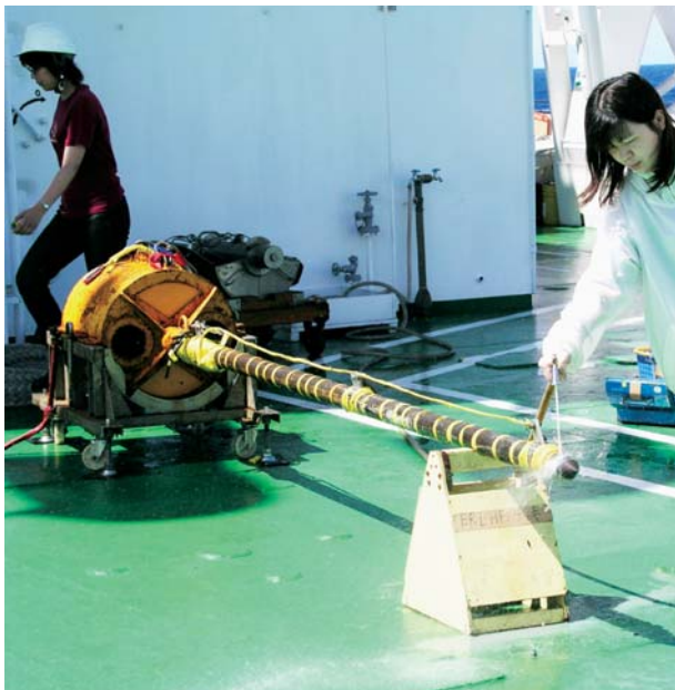
図18 バイオリンボウ型の温度センサーを用いた熱流量測定機器の写真.
