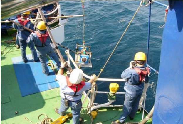
図2 地球電場観測装置1号（左）および2号（右）の回収の様子
