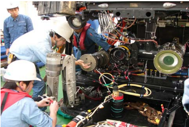
図3 現場比抵抗測定装置（左：研究者が触っている耐圧容器）と展長用ケーブル（右：長さ約 10m）
