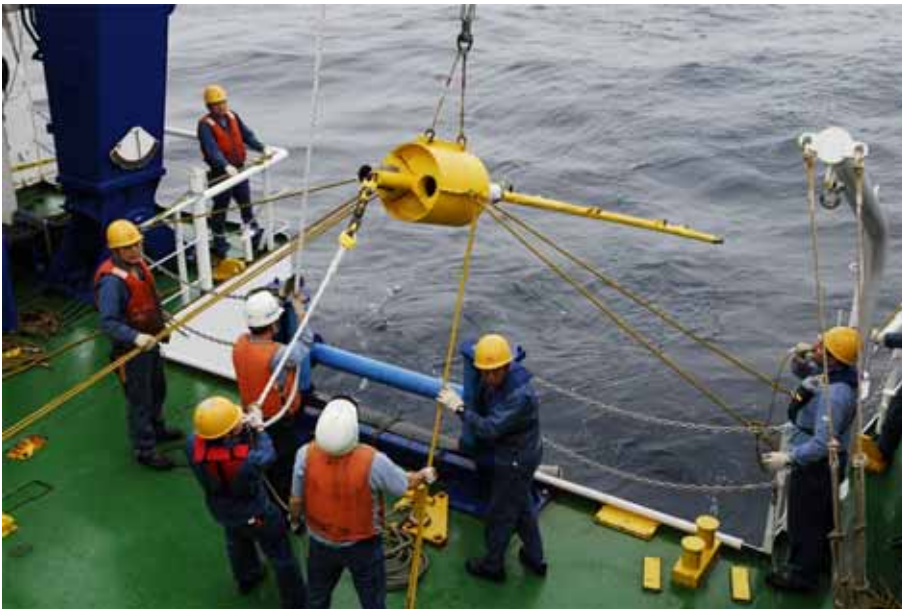
写真 4 : 地殻熱流量測定を行 うための HF プローブ .
