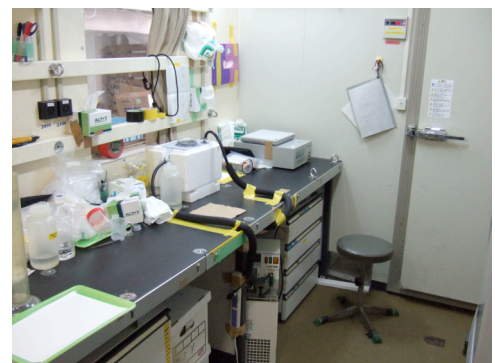
図4. コンテナラボ内に設置したガスクロマトグラフィー。硫化水素の産生能を規則した。
