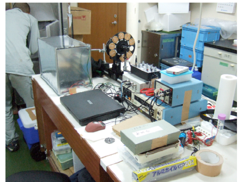
図3. 電気生理実験器具一式。バラビクニンの網膜を取り、様々な波長の光を照射して、その反応を記録した。
