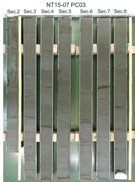
図2 Mid-slope terrace で採取されたコアの岩層。地震性タービダイト起源と推定される砂層（黒色の層）を頻繁に含む。
