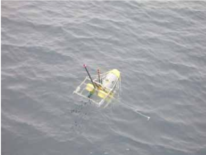
図4 海面に浮上した直後の長期電磁気観測装置。
