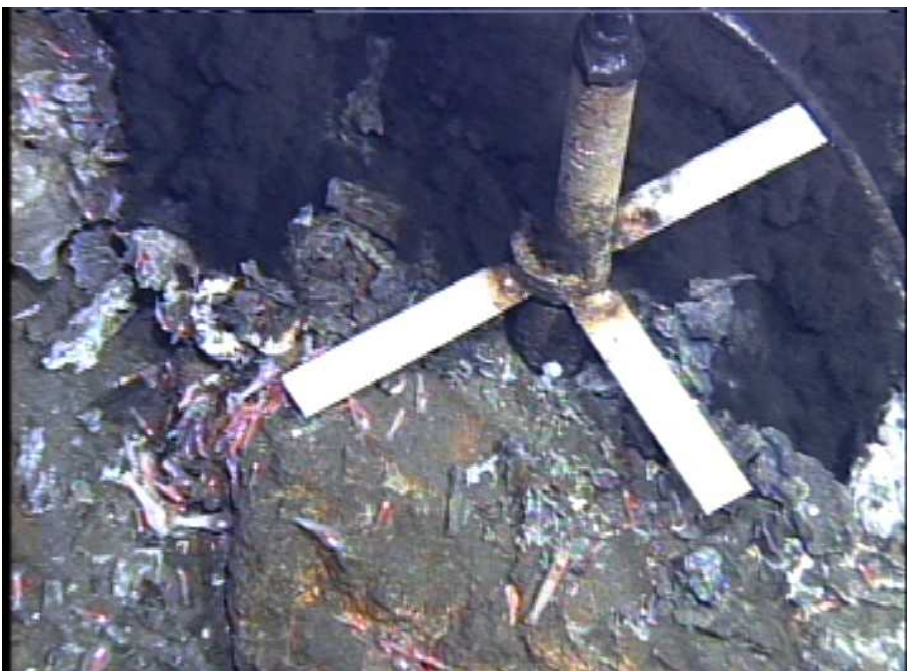
Kairei Field Kali vent に設置された現場培養器（10日間）
