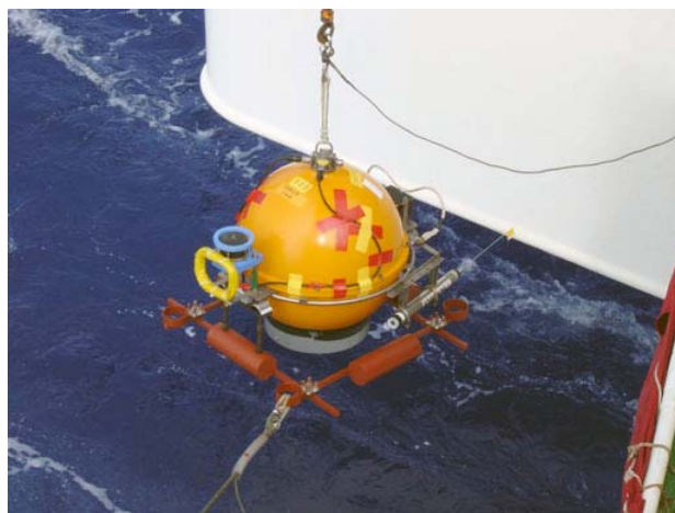
写真 1 広帯域海底地震計(BBOBS) 本航海で回収(左)・設置(右)した時の各一例。
