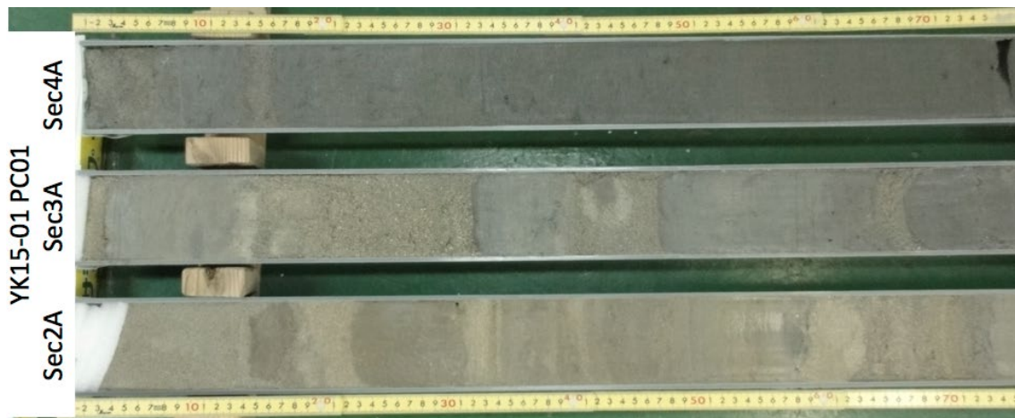
図2 YK15-01 PC01 コアの断面写真 (23-56.3055°N, 124-04.4122°E, 2,765m). 明るいインターバルは、サンゴ片や貝殻片を含むタービダイトに相当する。津波または地震により石垣島付近から深海にもたらされた可能性がある。
