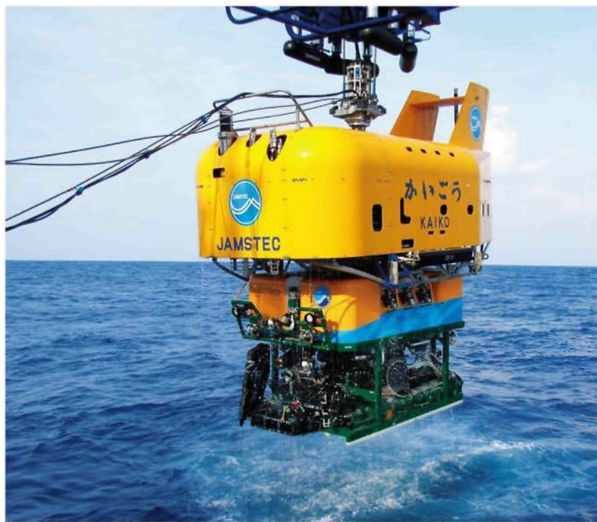
7,000m級無人探査機「かいこう7000 II」 7,000mという潜航深度は、現在、世界トップクラスを誇る。初代「かいこう」で行われてきた深海の観測・探査が継続的に進められることの意義は大きい。 ● 最大潜航深度 : 7,000m ● 寸法 (ピークル) : 全長3.0m 幅2.0m 高さ2.1m ● 搭載可能な機器重量 (ペイロード) : 50kg ● マニピュレータ : 右7自由度1基・左6自由度1基
