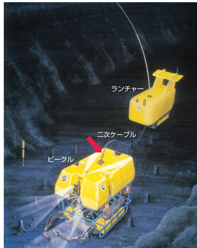
二次ケーブルとビークルの結合部近傍（矢印部分）で破断がおきた。下の写真は、破断したケーブルの先端部分
