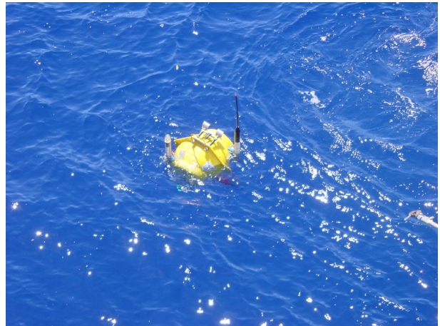
写真 4-4. 観測後浮上した海底地震計
