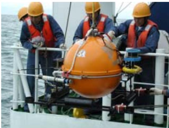
図10.平成13年7月31日に深海調査研究船「かきれい」からWP-2観測点付近に設置される海底設置型広帯域海底地震計.海上からの音響呼び出しで浮上させることができる.1年間の連続記録が可能である.
