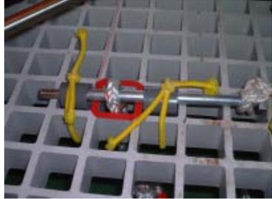
写真2：パレット下の係留索を切る手間を省くため、使用したピン
