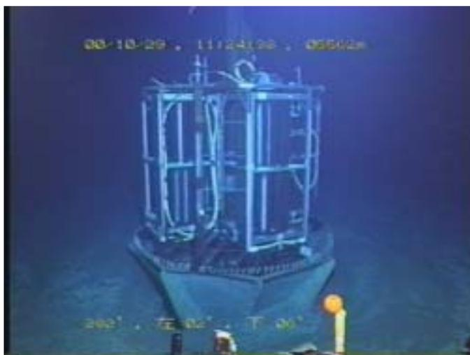
図7 . 無人探査機「かいこう」により撮影された北西太平洋海盆 WP-2 孔内広帯域地震観測システム海底部全景 . 電池・レコーダユニット (円筒状) の下に掘削中に利用するリエントリコーンが見える .
