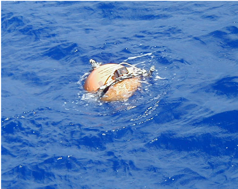
写真 6-1. 海面に浮上した長期観測型広帯域海底地震計(NOT1)
