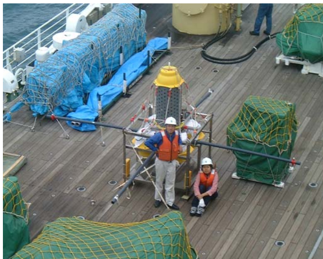
図9．平成13年7月27日に海洋地球研究船「みらい」でWP-2観測点付近に設置された絶対計搭載海底電位磁力計．海上からの音響呼び出しで浮上させる事ができる．1年以上の連続観測が可能である．
