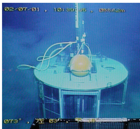
図 12. 深海調査研究船「かいれい」KR02-08 航海にて行われた「かいこう」ダイブ#251 にて、長期観測態勢に入った WP-2 観測点（平成 14 年 7 月 1 日）。オレンジ色の球型耐圧容器にレコーダとバックアップ電源が入っている。
