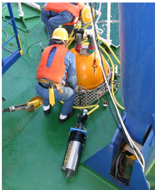
写真 2. 「かいこう 7000」ダイブ#340 にて、「かいいい」船上に回収されたチタン 球 SAM システム。
