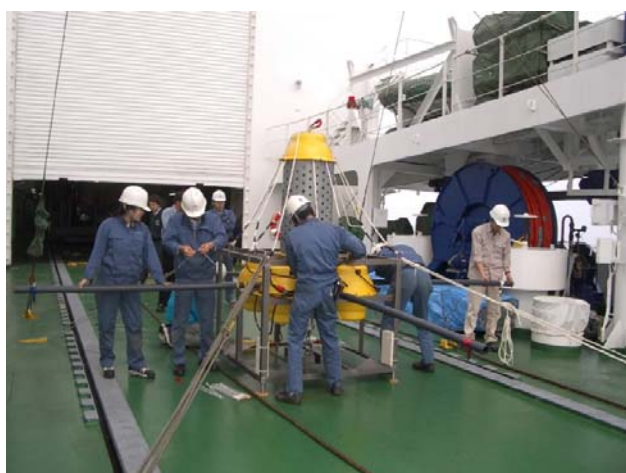
写真 4. 組み立て中の海底長期電磁気観測装置
