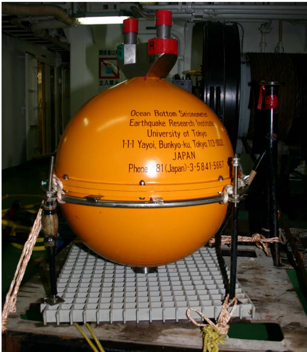
写真1 KR02-08次航海でWP-2海底孔内広帯域地震観測点に設置された海水電池併用型チタン球SAM
