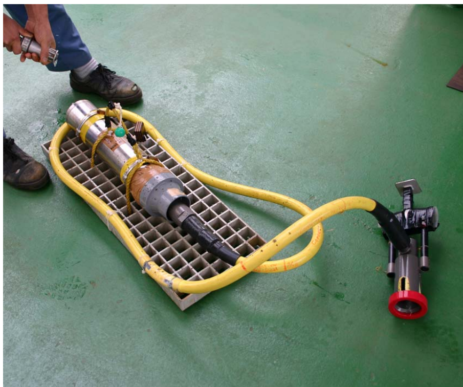
写真4 「かいこう 7K」ダイブ#341にて、「かいいい」船上に回収された海水電池データレコーダ (DL) 本ダイブを持って、WP-2 北西太平洋海盆孔内広帯域地震観測所は観測休止状態となった。
