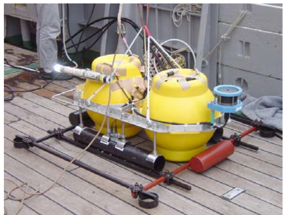
写真 5. 長期観測仕様の超深海型海底地震計の外観
