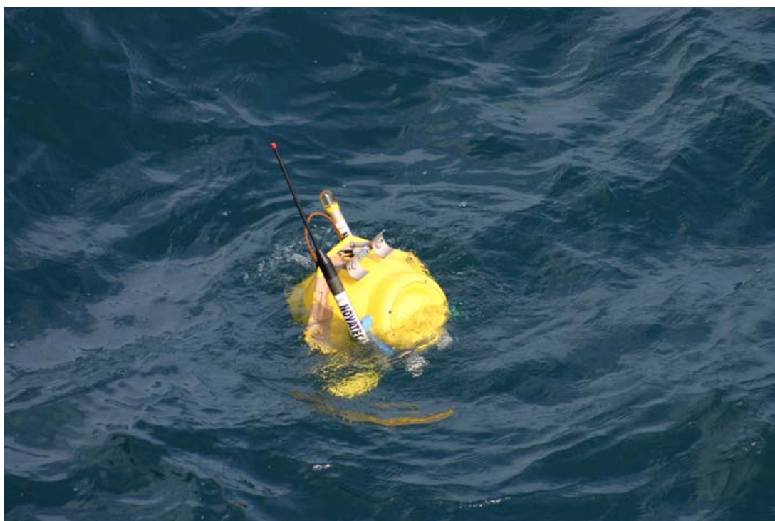
写真3. 観測を終了し、浮上した海底地震計
