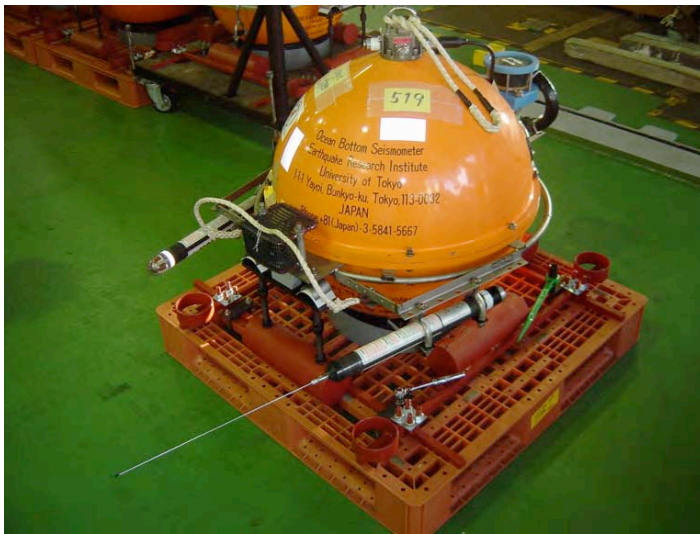
図 4 BBOBS(T09)の外観。直径 65cm のチタン球を使用。
