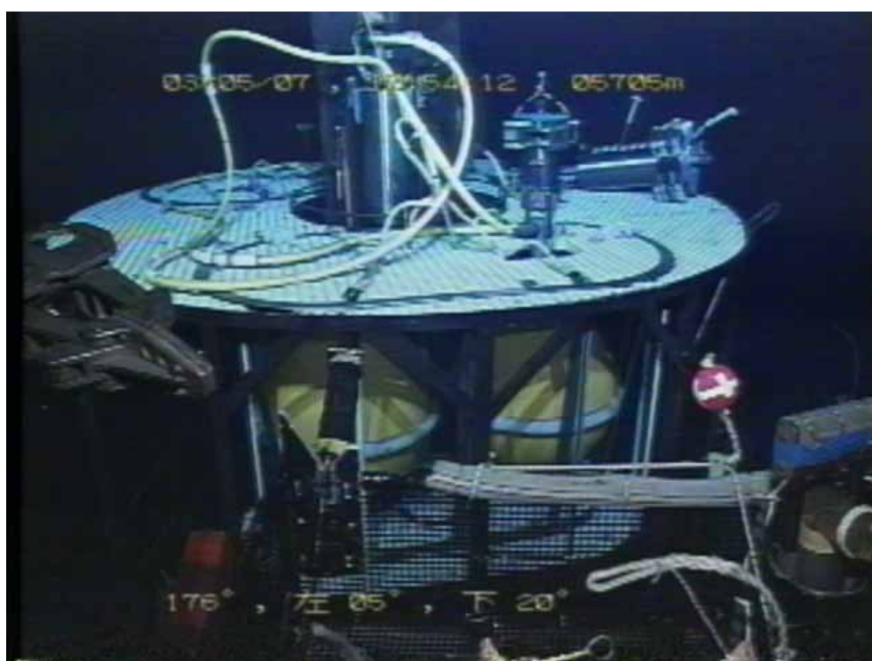
写真2 KR03-04 で確認されたプラットフォームのリチウム電池ユニット
