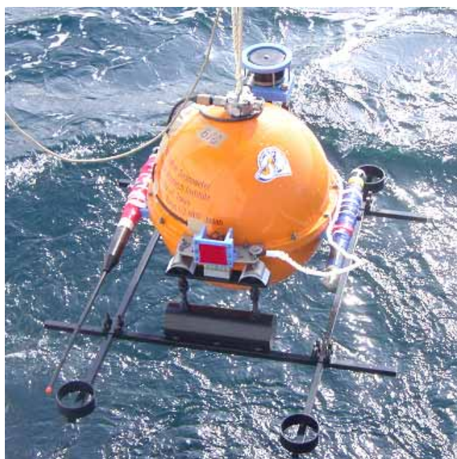
写真5 KR03-04 で設置された SWSB2 (投入前). 耐圧容器の直径は, 65cm.
