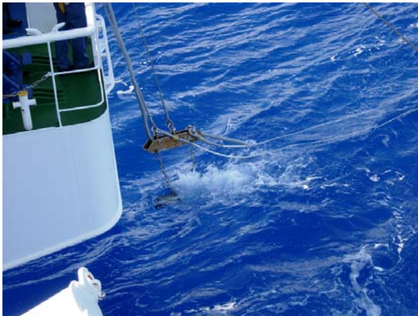
写真1. 「かいりい」船尾より投入されるGIガン(2006年6月18日)
