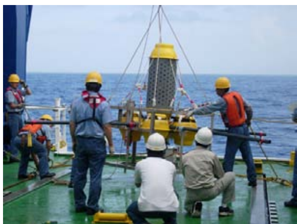
写真 4. 投入される海底長期電磁気観測装置（絶対計搭載型海底電位磁力計）
