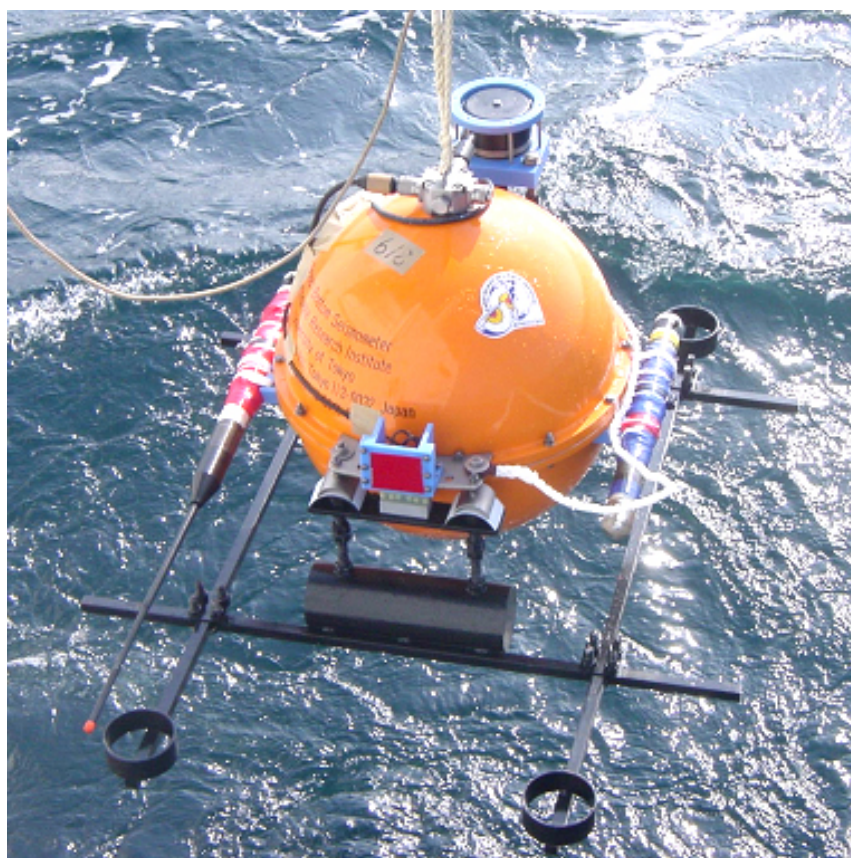
写真1. LS18 に設置されている海底地震計と同型の長期観測型海底地震計
