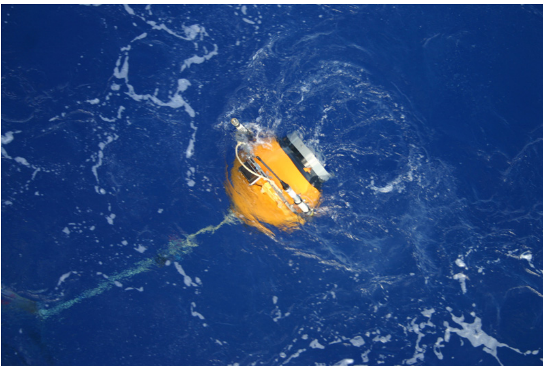
写真3 「かいこう 7000II」を船上に回収している間、「かいいい」にゆっくりと曳航される SWSB2. 回収用のロープが水中にあることがわかる.
