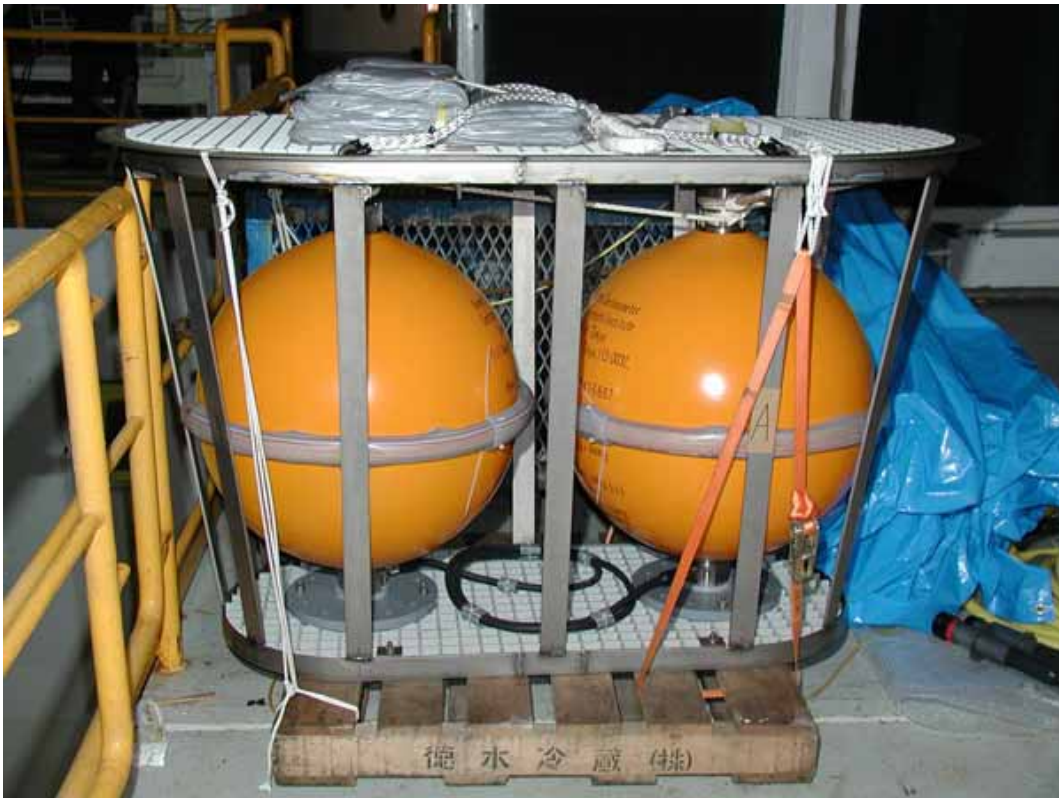
写真3 リチウム電池ユニット (設置前)
