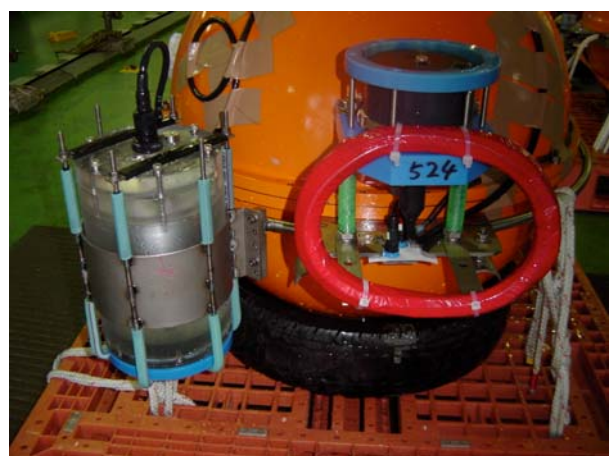
図 4. 2. DPG を追加装備した BBOBS (T07)。左：設置前の全体像、右：回収した状態。
