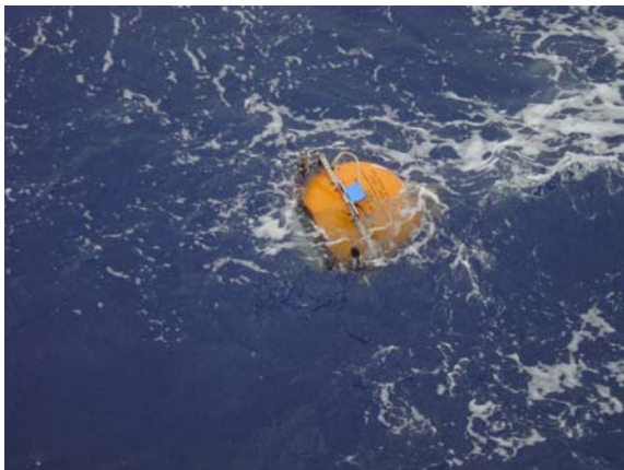
図 4. 1. BBOBS (T09)の外観、本航海での設置前(上)、及び回収時浮上中(下)。
