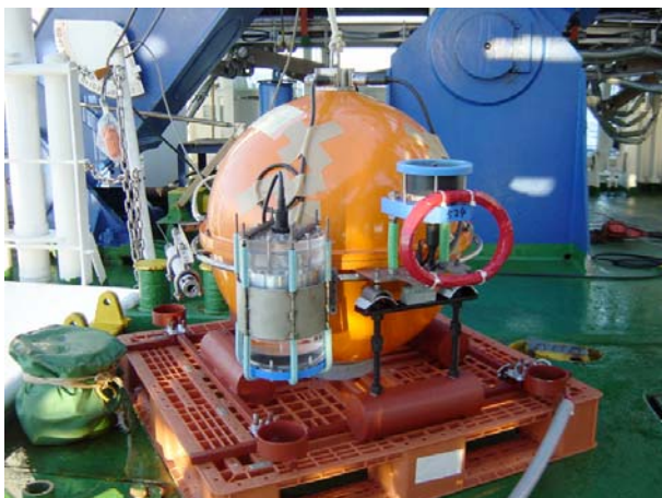
図 4. 2. DPG を追加装備した BBOBS (T07)。左：設置前の全体像、右：回収した状態。
