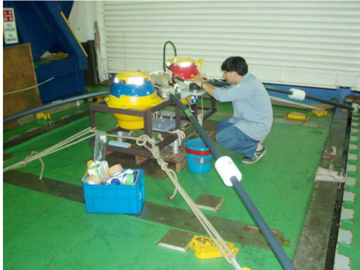
図 4. 6. 1 段型 OBEM (ERI12)。ERI13 も同型で共に地震研所有。先取りブイには直径 90mm のセラミックブイ 2 個を使用。
