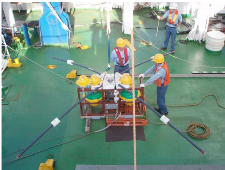
図 4.5. 2 段型 OBEM (JM1)。JM2, JM4, JM6 (以上 IFREE 所有), TT6, TT7, TT8 (以上地震研所有) も外装はほぼ同じ。上段の小ガラス球のうち左側のものは先取りブイ。他の二つは固定ブイ。
