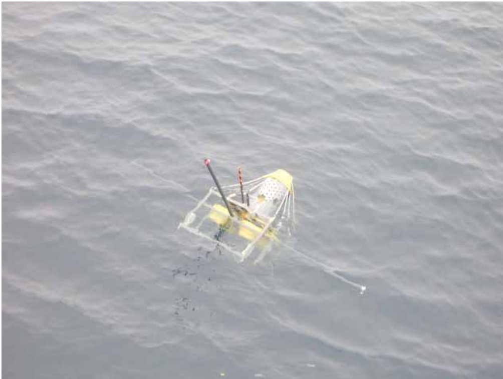
図4-3-3. 浮上した SFEMS4。浮上姿勢は概ね設計通りだが、オーバーハウザー・センサーを支えている塩ビの筒の側面に、大きな穴が複数開いている事が分かる。
