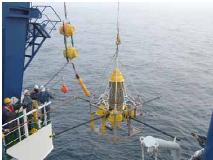
図3 長期電磁気観測装置の設置の様子。
