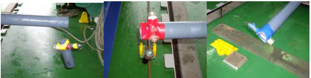
図 4-3-4. 破損した電極。取り付け位置の所で PP パイプが折れてしまっているものの電極と電位線共に無事なもの（左）、電極自体が破壊されパイプ先端が折れてしまっているもの（中）、パイプ先端が折れただけで済んだもの（右）の三つに分類できる。
