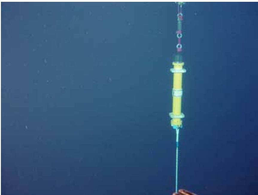
図 4-2-7 投入した SFEMS1 号機 (ST1) の上部のロープ (上) と係留系のトランスポンダー (下)
