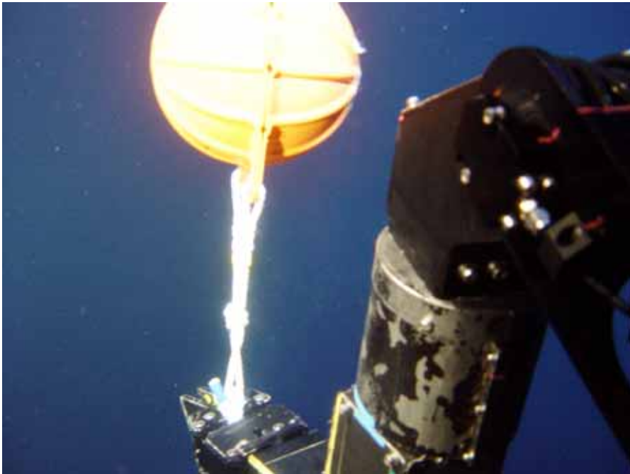
図 4-2-8 係留系の最上部のガラス球とST1 運搬のためのビークルのアームによる捕捉位置を示す
