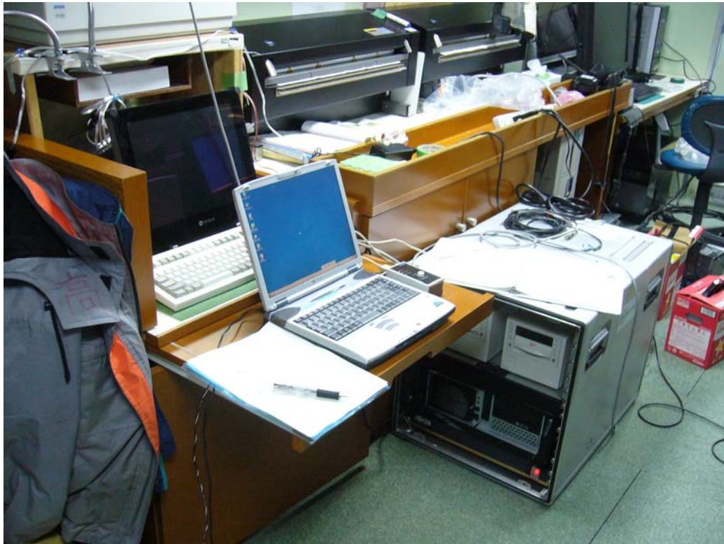
図 4-2-4. CNT2 探鉱機およびバックアップ用 DLT テープ装置。 手前のノート PC はストリーマ深度センサー用の PC (日海事所有)
