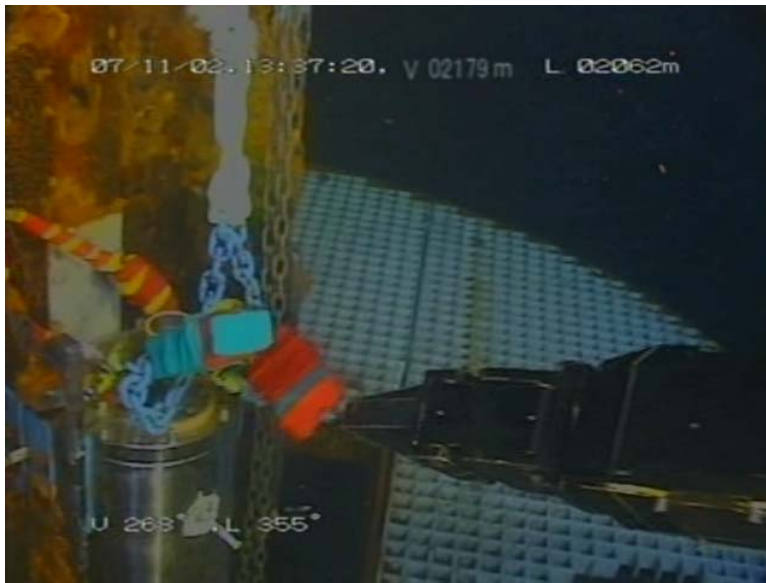
図 5-1-2-9. もう一方の GBox のアイボルトにフックを装着した様子.
