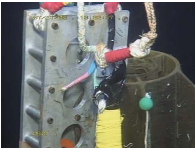
図 5-1-2-27. 13:22 係留系回収索フックをチェーンブロックに結合.
