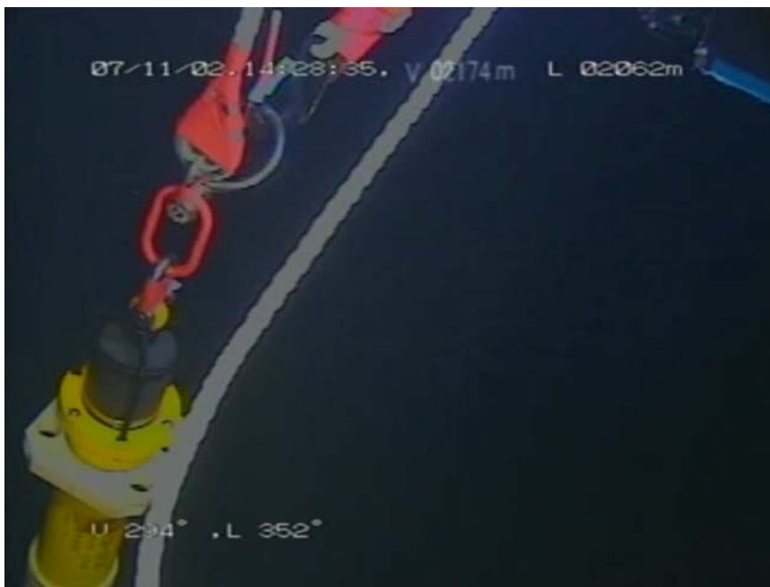
図 5-1-2-14. 他端のフックをトランスポンダーに掛けた時の状況.
