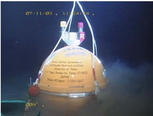
図 5-1-2-20. 11:24 SAM を Platform から離れたところで着底させ， マニピュレーターの右手から離す。
