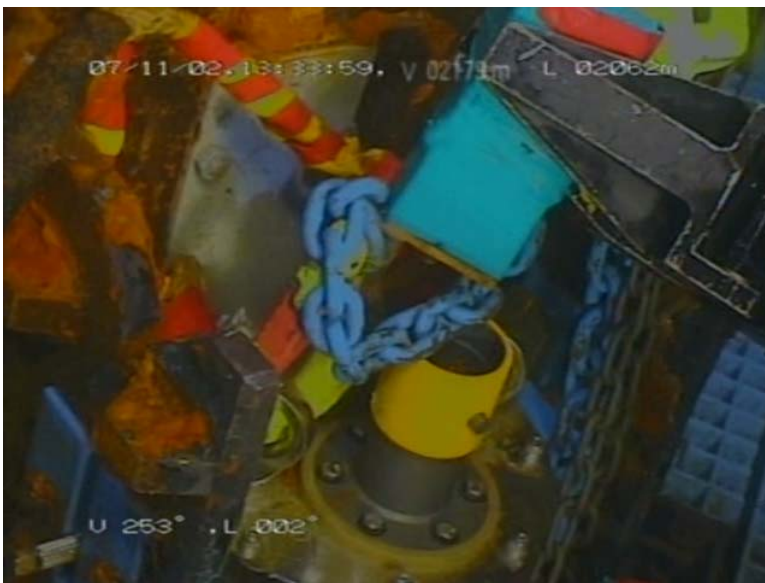
図 5-1-2-8. 一方の GBox 容器上のアイボルトにフックを装着した様子.
