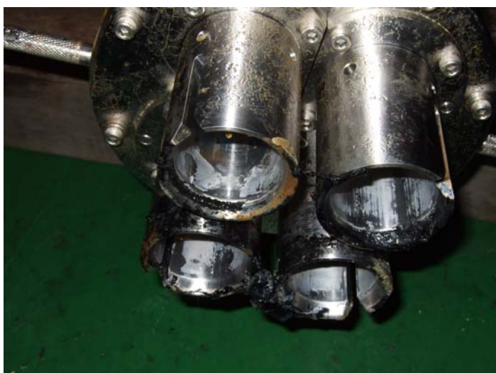
図 5-1-2-16. GBox 容器の掘削孔側のコネクタの腐食確認.
