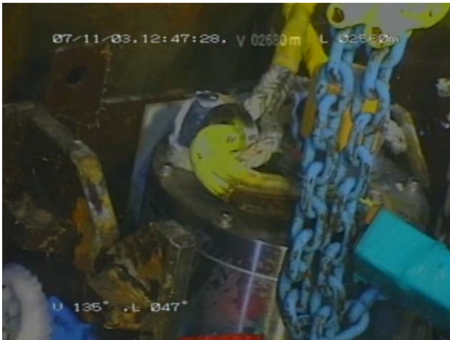
図 5-1-2-23. 12:46 G-Box の一つにフックを引っかた時の外観.
