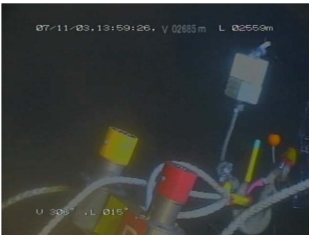
図 5-1-2-29. 13:59 ビーグルの回収フックにSAMを結合. その後, 離底し, ランチャーへ向かう.
