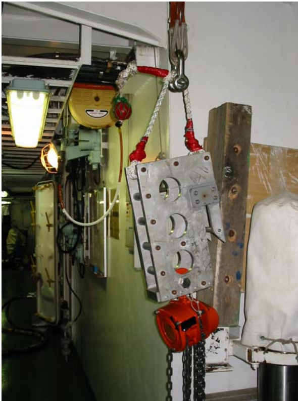
図 4-3-1-5. GBOX 回収用ハンガーとチェーンブロック.
