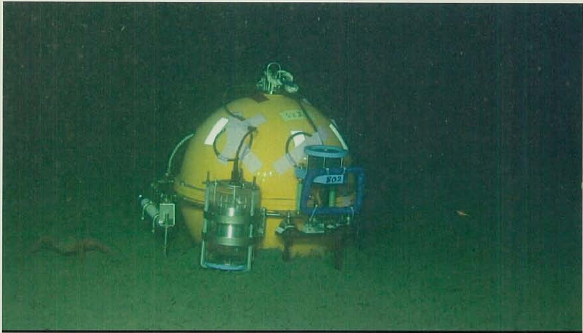
図-9 2007/11/19 にみた広帯域海底地震計の設置状態。
