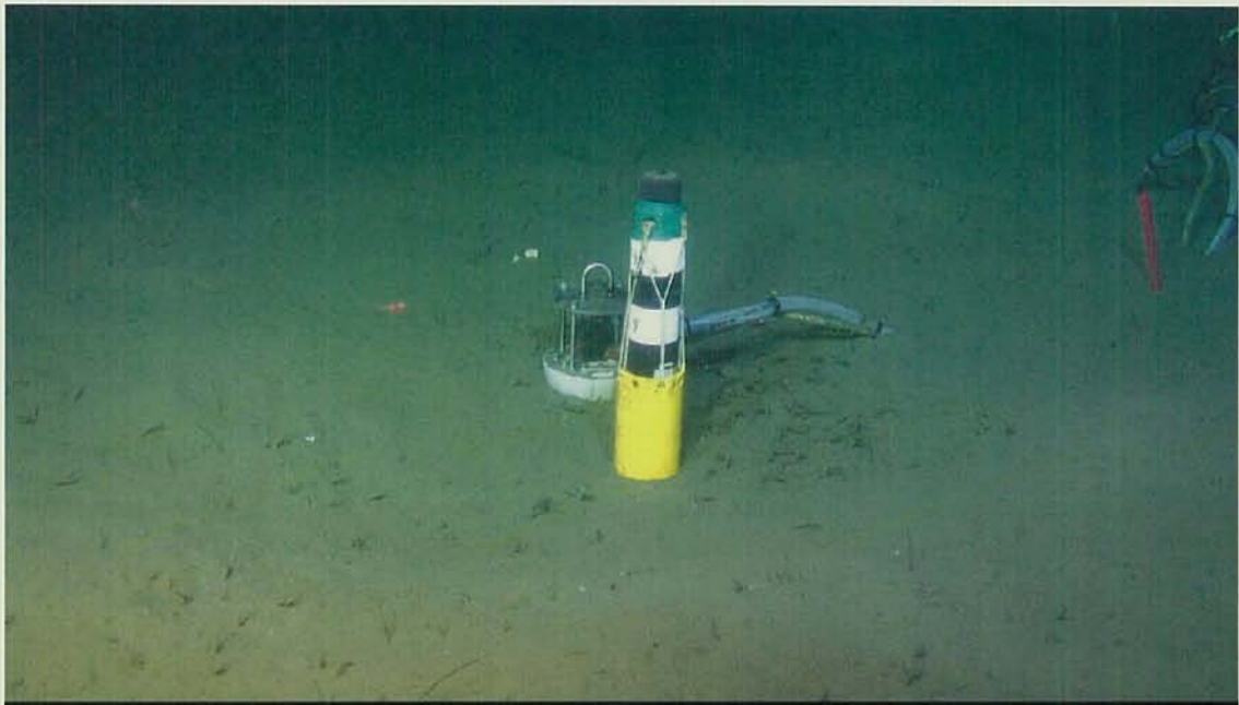
図-7 孔内地震計の周囲には堆積物の下に鉄の円板が入っているがその上に積もった堆積物に生物が繁殖している。
