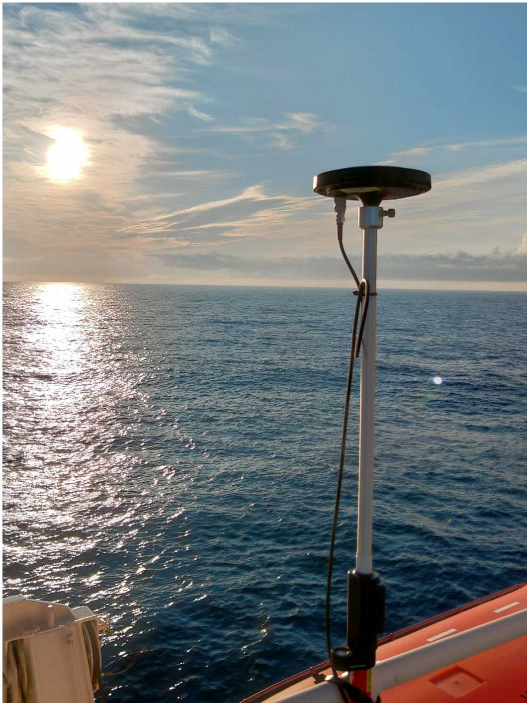
羅針盤甲板の手摺に取り付けた GNSS アンテナ
