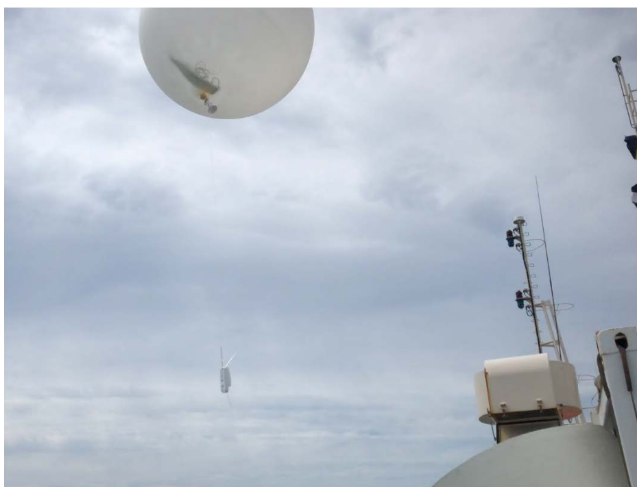
自動放球装置より放球直後のラジオゾンデ
