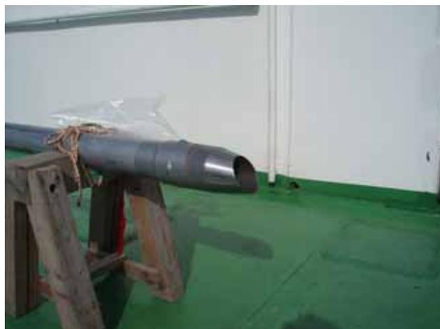
写真 2 先端を改造したビット
