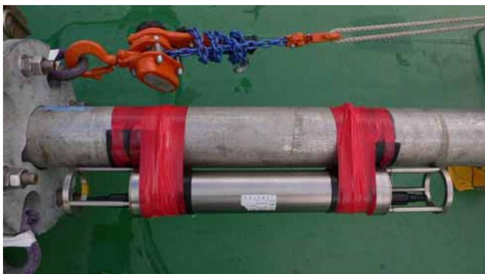
写真 5.2.2-1 深度計付き加速度方位傾斜計 (S/N002)
