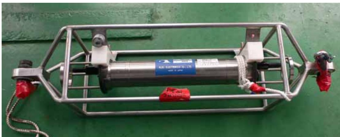
写真 5.2.2-2 深度計付き加速度方位傾斜計 (S/N003)
