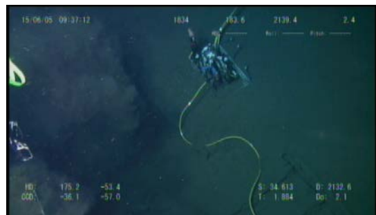
(d) Connection with the battery package
