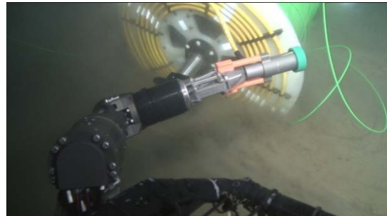
(d) Cable bobbin with cable on the seafloor
