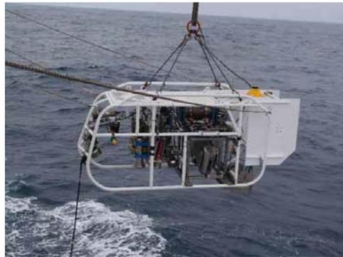
写真 3-2-1-1 4,000m 級ディープ・トウ カメラ水中部
