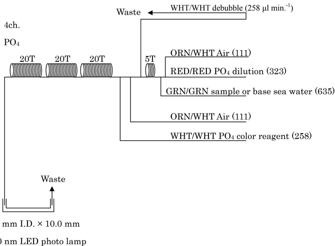
Figure 4.2.5 PO<sub>4</sub> (4ch.) Flow diagram.
