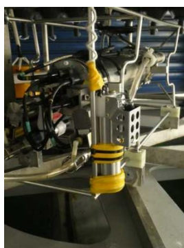
Fig. 5.13.4-2 Mounting of JES10 mini on CTD System
