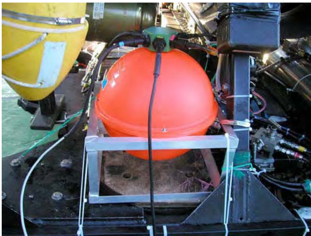
写真 2 ハイパードルフィン (ROV) に取り付けた DAI-PACK の耐圧容器
