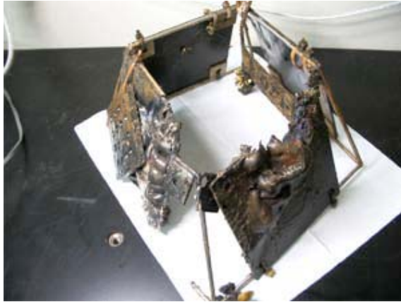
図 1. 回収した付着板 H420-1 手前の塩ビ板からはスレート板が脱落し、塩ビ板、ステンレス製枠も腐食、損傷している。
