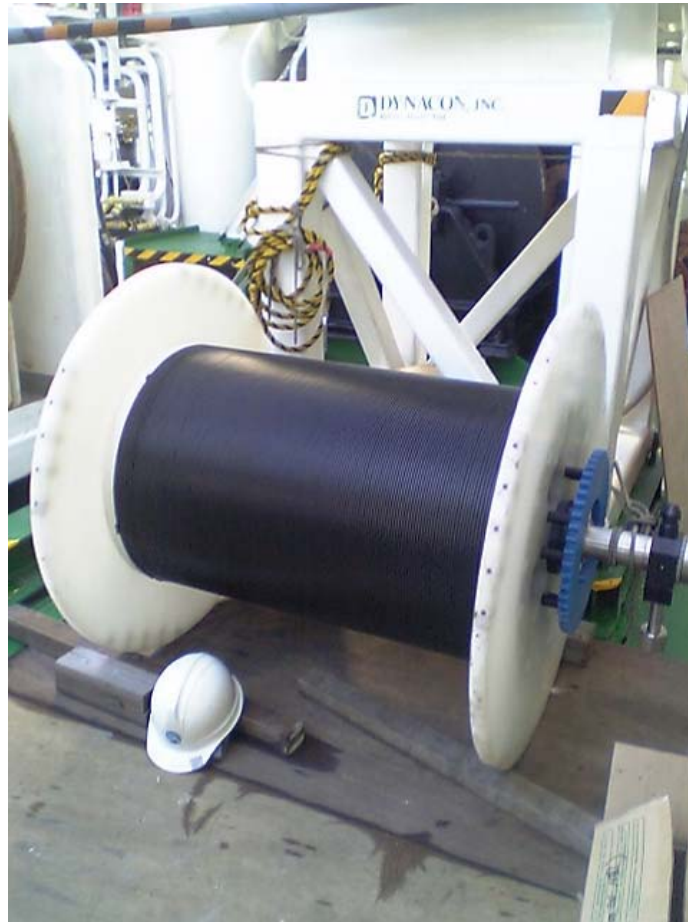
図 5-2-2-4. ボビンに巻き込まれた 300m ケーブル
