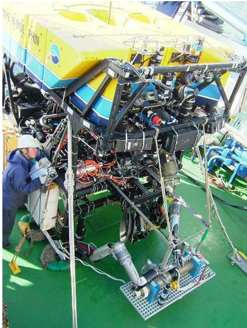
図 5-2-2-9. 実際の搭載時の様子（HPD Dive #640 潜航直前） 万が一、吊り下げフレームや、フレームと記録計を止めているピンが 着水時に外れてしまった場合を想定して取り付けられた命綱が見える （記録計からハイパードルフィン右舷前へ伸びている）。
