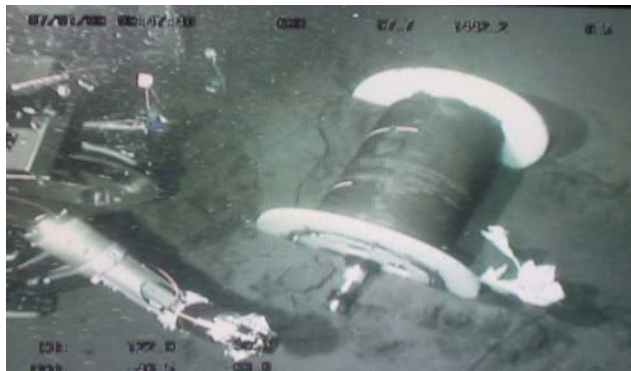
写真4. 3. 4－1 ボビンに接続される勘合金物
