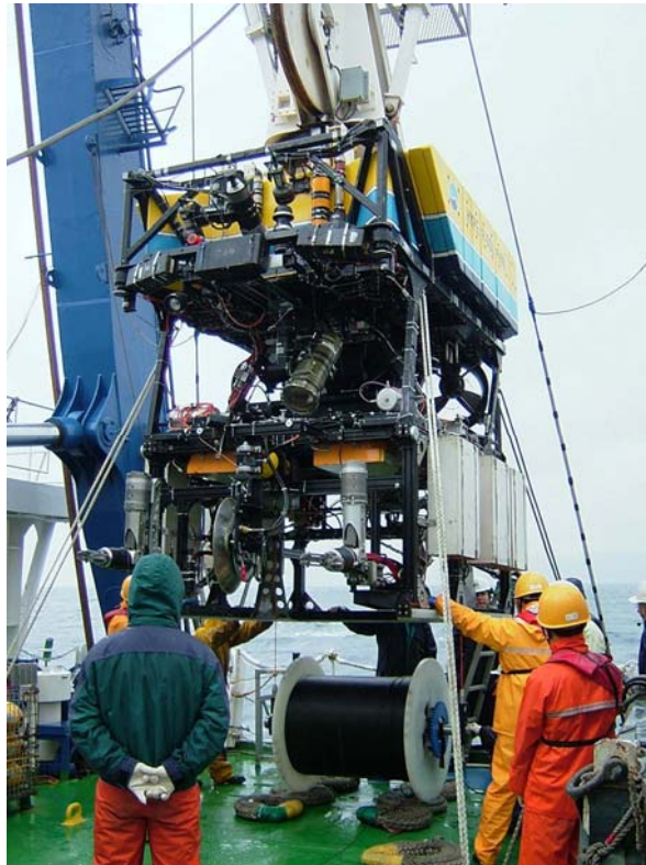
写真4. 3. 3-1 展張装置とケーブルボビン
