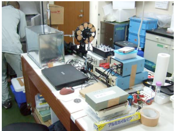
図5. 船上生理実験機器。様々な波長の光をバラビクニンの網膜に照射し、電気生理的な応答を調べた。
