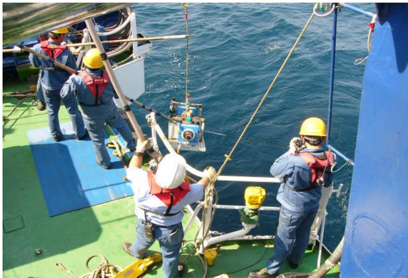
図 10. EFOS1 号機、水きり。この後、人力により 300m ケーブルを揚収した。
