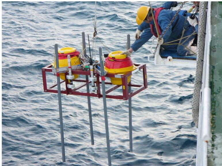
図 10. 水面浮上時の OBEM（上）および揚収時の OBEM
