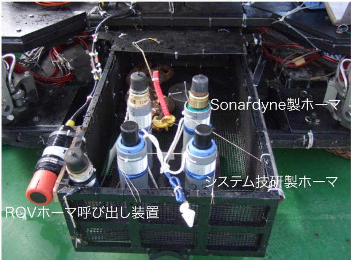
写真1. ROV ホーマ呼び出し装置とダイブ#825 で搭載した ROV ホーマ
