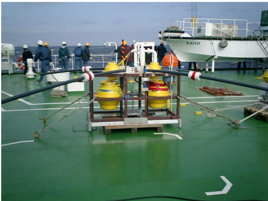
図4. ガラス球2球型 OBEM の外観 (旧タイプ) .
