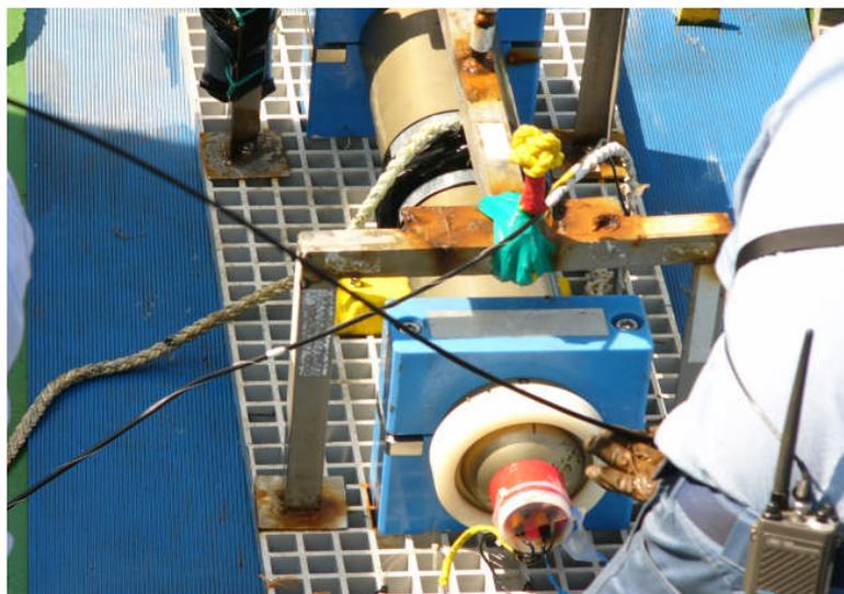
図 11. 揚収後の 300m ケーブル（上）と EFOS1 号機の記録計（下）
