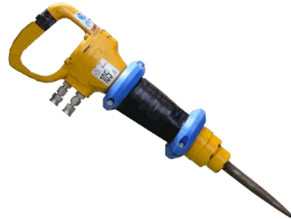
Fig: 10 Rock breaker
