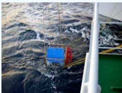
投入されるシャトルエレベータ
