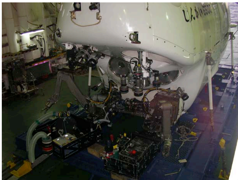
写真 1 しんかい 6500 Dive 917 に搭載したディープアクアリウム捕獲装置
