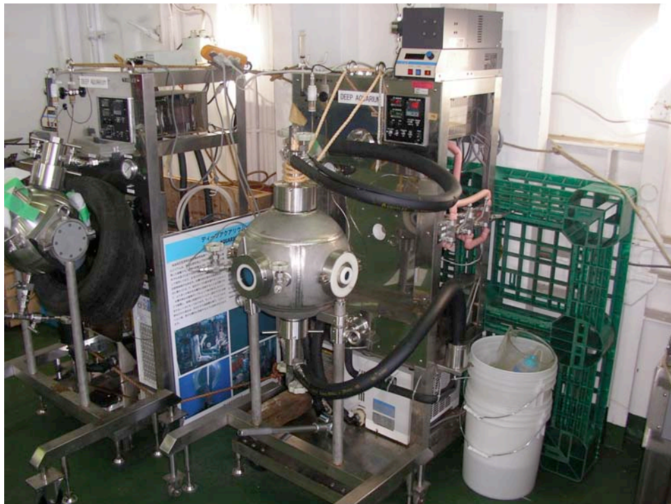
写真3 母船よこすかに設置したディープアクアリウム加圧飼育装置
