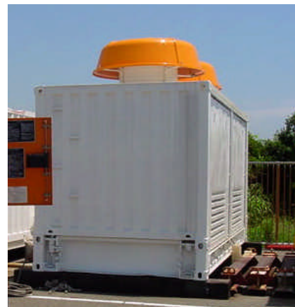
写真2: コンプレッサー外観
