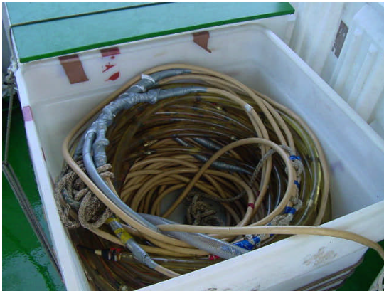
写真7 ストリーマーケーブル収納箱
