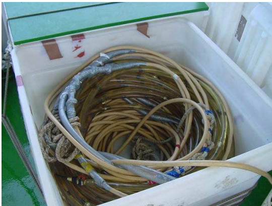
写真7 ストリーマーケーブル収納箱
