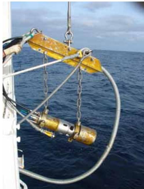
写真-3 GI-Gun 低速曳航式
