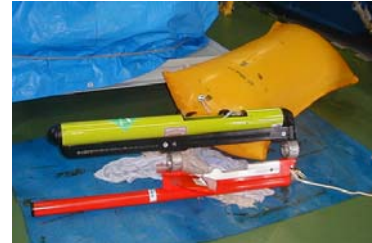
写真-3 リカバリー装置付深度調整器 (ブイ作動状態)
