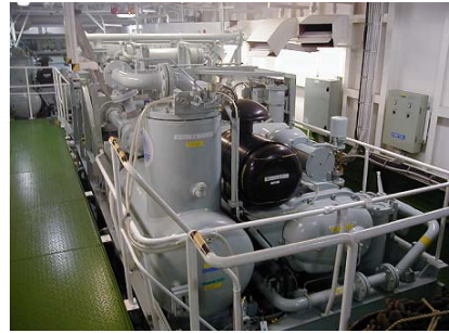
写真-2 船体固定コンプレッサー概観 (「かいいい」船体装置：取外し不可)
