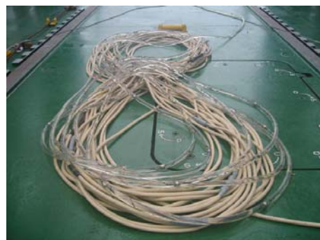
写真-5 ストリーマーケーブル
