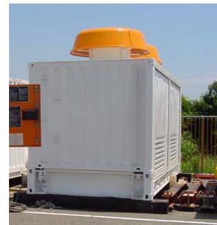
写真-1 可搬式コンプレッサー概観 (20feet コンテナ型)
